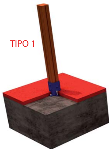
FIJACION A SOLERA DE HORMIGON
