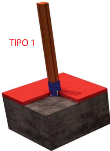
FIJACION A SOLERA DE HORMIGON
