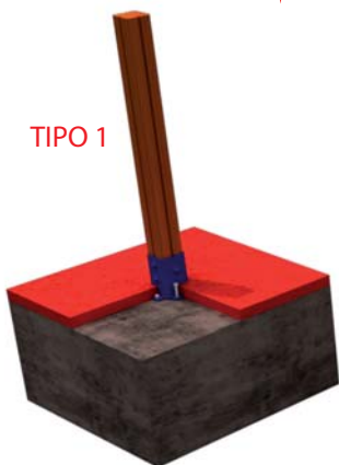
FIJACION A SOLERA DE HORMIGON
