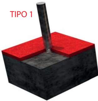
FIJACION A SOLERA DE HORMIGON
