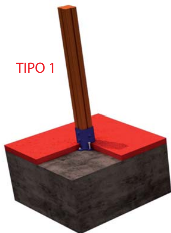
FIJACION A SOLERA DE HORMIGON
