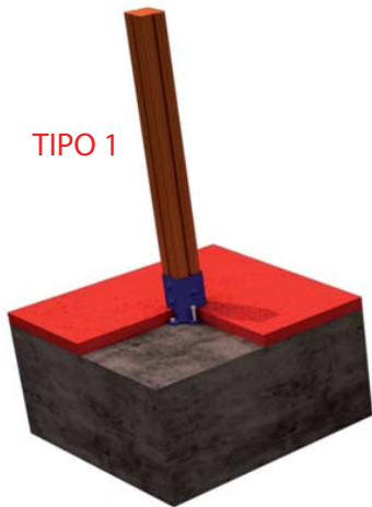
FIJACION A SOLERA DE HORMIGON
