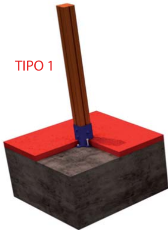
FIJACION A SOLERA DE HORMIGON
