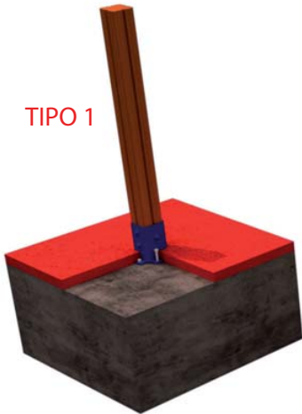
FIJACION A SOLERA DE HORMIGON
