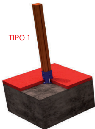
FIJACION A SOLERA DE HORMIGON
