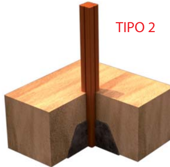
FIJACION A SUELO BLANDO
