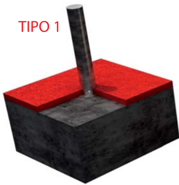
FIJACION A SOLERA DE HORMIGON
