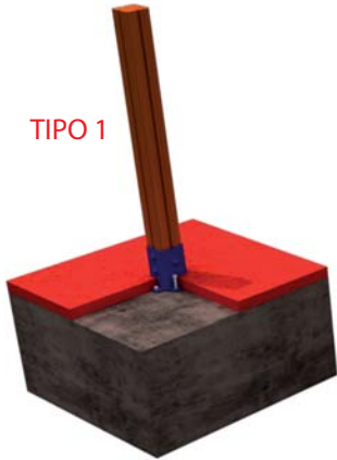
FIJACION A SOLERA DE HORMIGON
