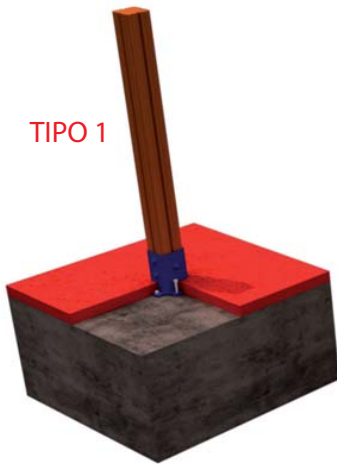
FIJACION A SOLERA DE HORMIGON
