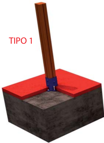
FIJACION A SOLERA DE HORMIGÓN
