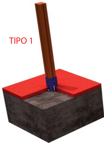
FIJACION A SOLERA DE HORMIGON
