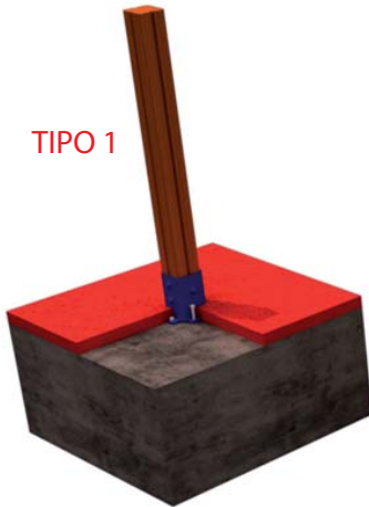
FIJACION A SOLERA DE HORMIGON
