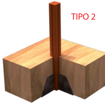
FIJACION A SUELO BLANDO
