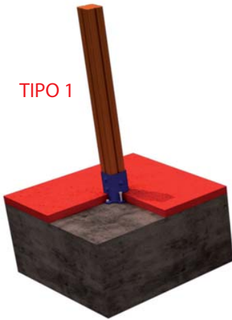
FIJACION A SOLERA DE HORMIGON
