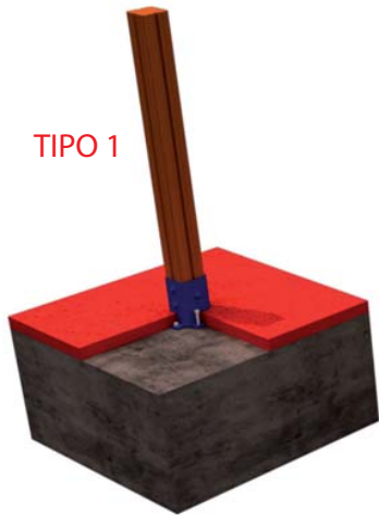
FIJACION A SOLERA DE HORMIGON
