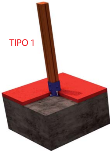
FIJACION A SOLERA DE HORMIGON
