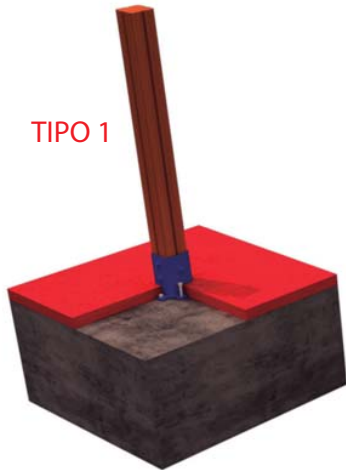
FIJACION A SOLERA DE HORMIGON
