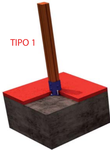
FIJACION A SOLERA DE HORMIGON
