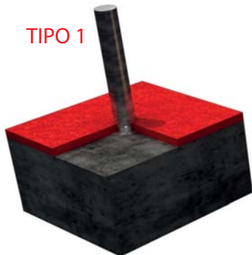
FIJACION A SOLERA DE HORMIGON
