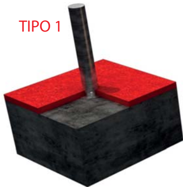
FIJACION A SOLERA DE HORMIGON
