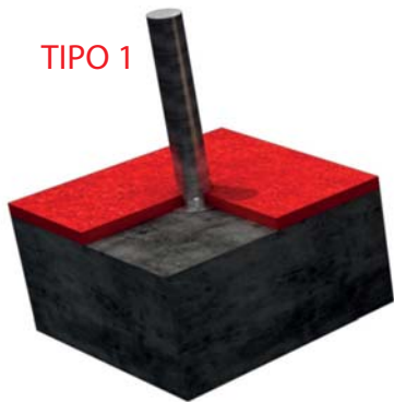
FIJACION A SOLERA DE HORMIGON
