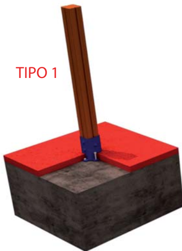
FIJACION A SOLERA DE HORMIGON
