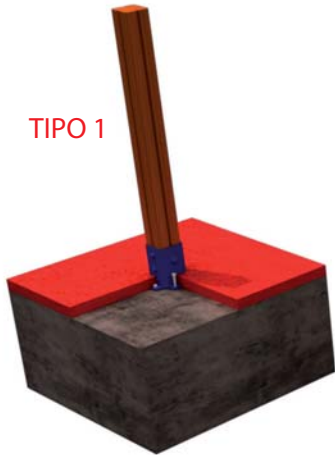
FIJACION A SOLERA DE HORMIGON
