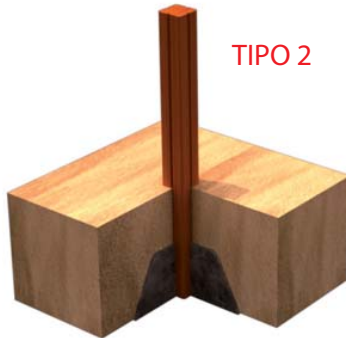
FIJACION A SUELO BLANDO
