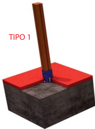
FIJACION A SOLERA DE HORMIGON
