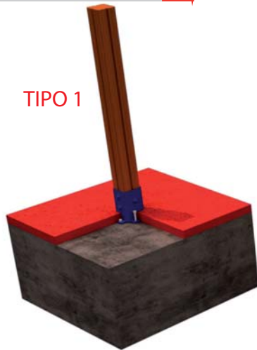
FIJACION A SOLERA DE HORMIGON
