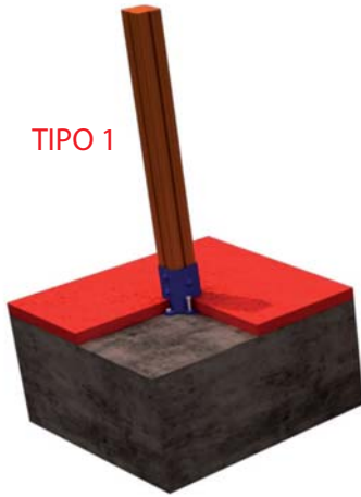
FIJACION A SOLERA DE HORMIGON
