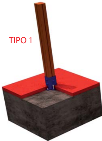
FIJACION A SOLERA DE HORMIGON
