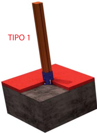
FIJACION A SOLERA DE HORMIGON
