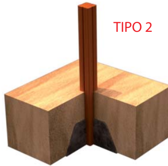
FIJACION A SUELO BLANDO
