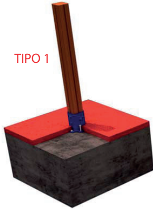
FIJACION A SOLERA DE HORMIGON
