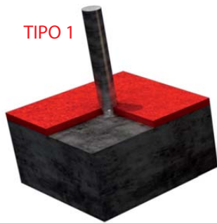
FIJACION A SOLERA DE HORMIGÓN
